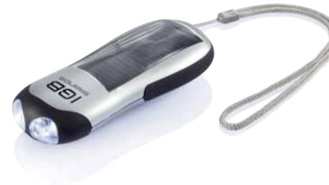
Silbernes Kunststoffgehäuse mit Solarflächen (1,2V), Ni-MH-Batterie (eignet sich auch für 2 AAA Batterien), 2 weiße LED Lampen.
